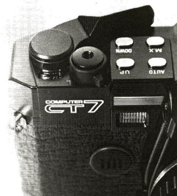
Det utraditionelle trykknapp-panel, der erstatter en drejknapp. På fronten ses vindue/trykknapp for selvdøser samt biip-højttaleren.
